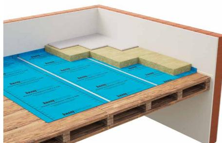
Für den begehbaren Dachboden auf Holzbalken- oder Massivdecke eignen sich druckfeste Dämmplatten aus Steinwolle mit harter Auflage wie Fertigteilestrich oder Spanplatten.
